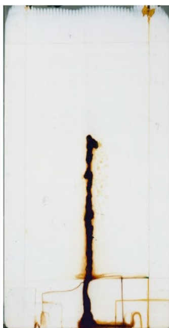
NSST×1440 小時 Gardobond OC panel 乾膜厚：約 110μm
