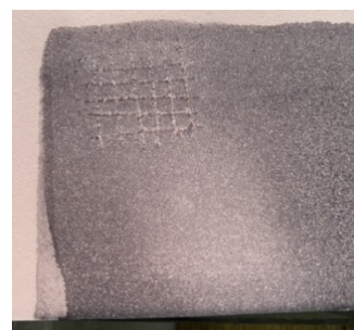
Test 1 百格處為材破，判定 5B
