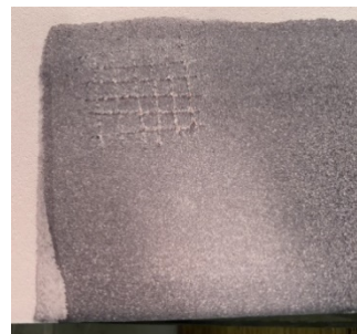
Test 1 百格處為材破，判定 5B
